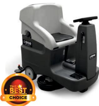
Carro de lavagem potente para áreas até 3.200 m<sup>2</sup>, com escovas duplas contra rotativas de 66 cm de diâmetro e pressão constante de 32 kg. Compacta e autónoma, possui depósito de 85 L, painel ergonómico, sistema automático de dosagem e tração traseira. Reduz significativamente os custos de limpeza.
